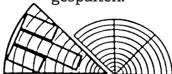
Die daraus entstandenen Scheite werden „angerissen“ und in entsprechende Dauben geschnitten.
